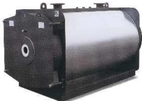
Котел REX-F полностью по конструкции идентичен котлу REX. Для увеличения КПД стальные турбулизаторы заменены на алюминиевые вставки с радиальными ребрами, таким образом увеличивается поверхность нагрева, уходящие газы отдают больше тепла и удаляются через дымоход с более низкой температурой по сравнению с традиционными котлами. Промышленная обшивка из высоко плотного изолирующего материала, внешне покрытая гофрированным алюминием. Рабочая температура 110°C.
