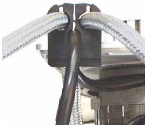
Вдеть резиновое кольцо в специальное гнездо в улитке горелки и затянуть винт **V**.
