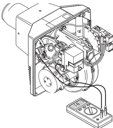
Контроль ультрафиолетовым датчиком
