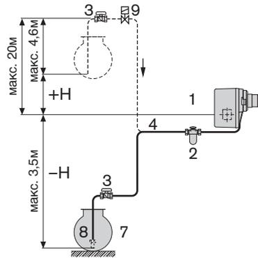
Рис. 2 - двухтрубная система
