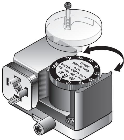
Для регулировки реле давления газа необходимо подключить манометр к месту измерения 1 клапана DMV. При определении момента переключения следить, чтобы он был не ниже половины регулировочного давления, и значение CO составляло < 1000 ppm.
