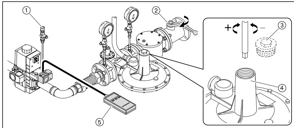
Предварительная настройка давления на регуляторе низкого давления
