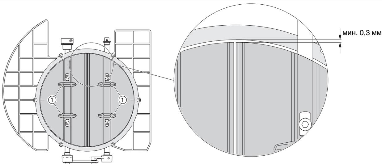
Если кольцевой зазор сверху менее 0,3 мм, открутить винты ① и горизонтально выровнять воздушные заслонки (равномерный кольцевой зазор сверху/снизу).
