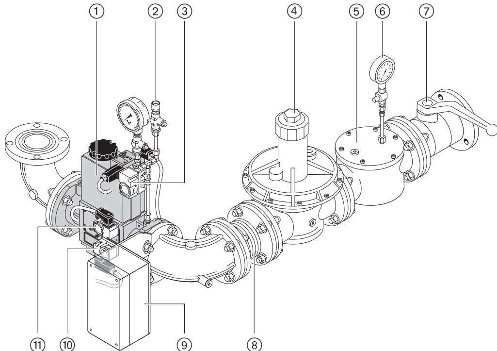
Пример монтажа арматуры низкого давления с двойным магнитным клапаном, резьбовое исполнение
