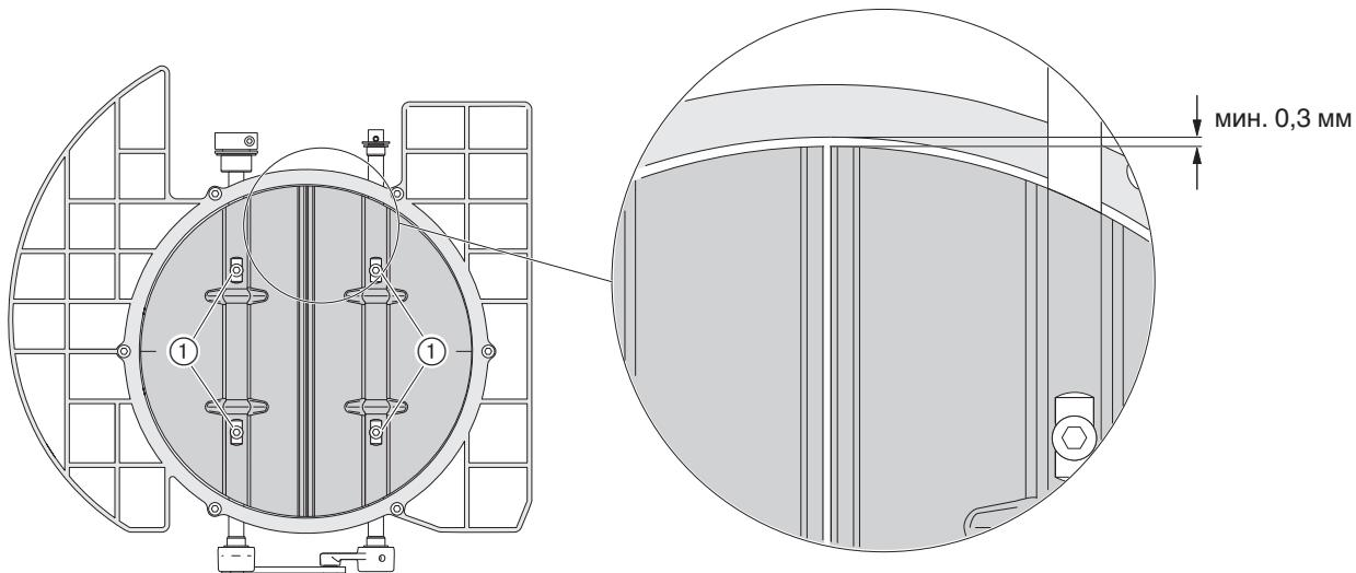
Если кольцевой зазор наверху менее 0,3 мм, открутить винты ① и горизонтально выровнять воздушные заслонки (равномерный кольцевой зазор сверху/снизу).
